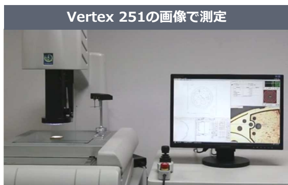
高輝度LEDマクロリングライト照明で測定
