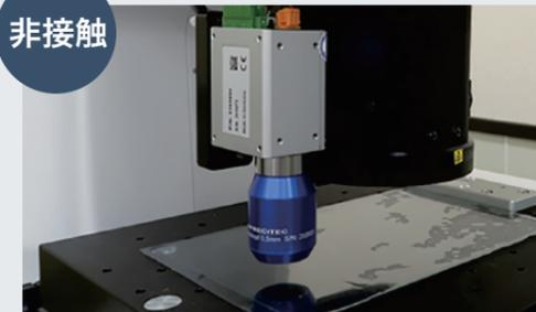
極小スポットサイズなので粗面、鏡面、透明体等の表面測定に最適な遮蔽効果の少ない白色光スキャナー測定 (Excel のみ)
