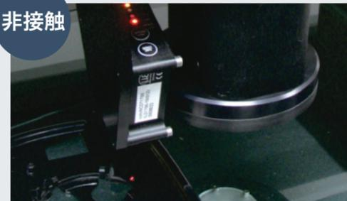
照明が届かない深い溝や凹凸面、粗い表面や鏡面等の測定に、非接触レーザー測定 (拡散、鏡面の共用モデル)
