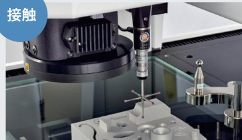
上から見えない部品側面の穴や溝の測定に、単一球、スター、ナックル、ディスクスタイルによる接触式タッチプローブ測定
