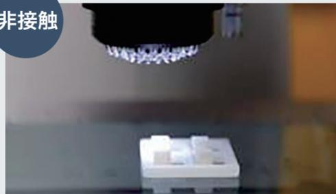
上から見える部品の輪郭や形状の高速、高精度測定に、カメラによる非接触式三次元画像測定 (XYZ 測定)
